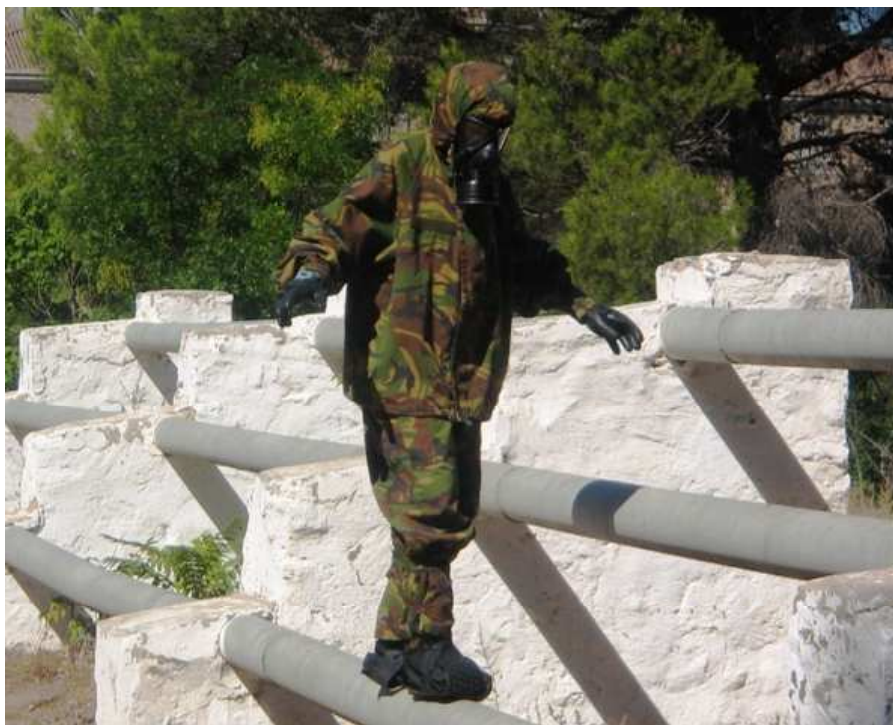
Figura 1. Voluntario realizando pruebas físicas y de habilidad para evaluar la capacidad de confort y maniobrabilidad de los trajes de protección NBQ ofertados al programa Combatiente del Futuro.
