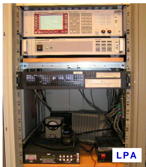
Figura 5. Arquitectura de comunicaciones HFD+VL y montaje físico del lado servidor
