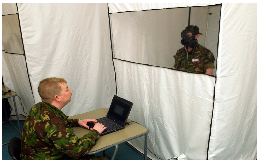
Figura 2. Macro-cámara acondicionada para crear atmósferas controladas que simulan un ataque con agresivo químico de forma que se ensaya del nivel de protección de la máscara.
