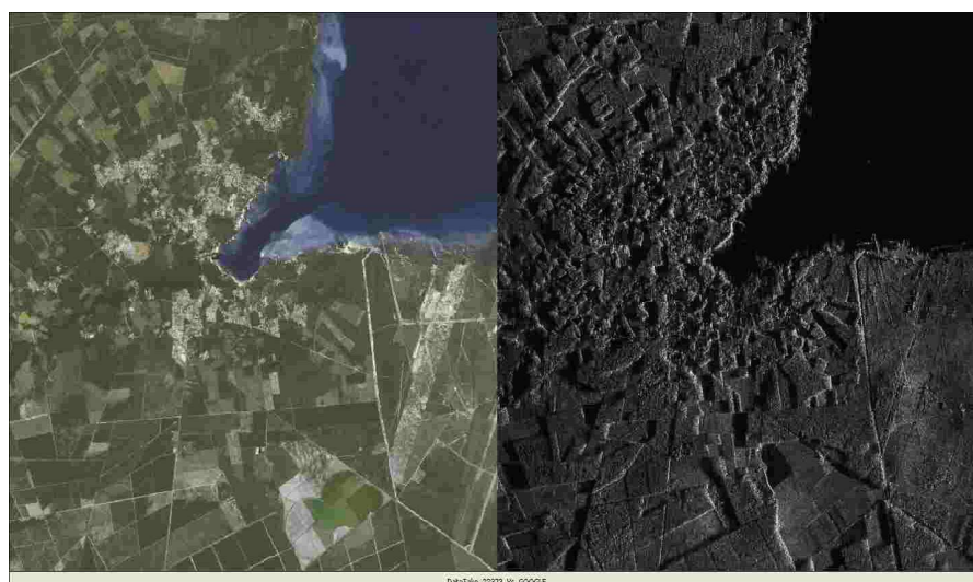
Figura 1. Comparación entre Imagen visible y swath SAR (desarrollado por Indra) de un mismo área obtenida con el SOSTAR-X.
