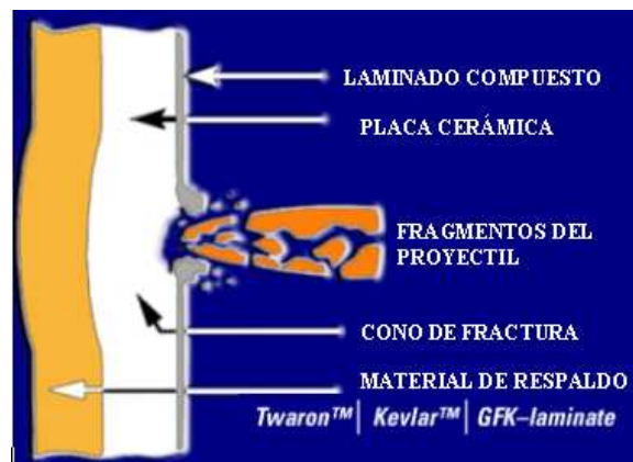
Figura 4. Esquema del impacto del proyectil sobre un blindaje multicapa.
